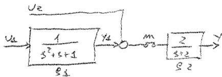
$$S1: \begin{pmatrix} \dot{x}_1 \\ \dot{x}_2 \end{pmatrix} = \begin{pmatrix} 0 & 1 \\ -1 & -1 \end{pmatrix} \begin{pmatrix} x_1 \\ x_2 \end{pmatrix} + \begin{pmatrix} 0 \\ 1 \end{pmatrix} u_d$$
