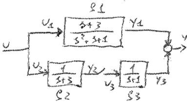
$$S1: \begin{cases} \begin{pmatrix} \dot{x}_1 \\ \dot{x}_2 \end{pmatrix} = \begin{pmatrix} 0 & 1 \\ -1 & -1 \end{pmatrix} \begin{pmatrix} x_1 \\ x_2 \end{pmatrix} + \begin{pmatrix} 0 \\ 1 \end{pmatrix} u \\ Y_1 = \begin{pmatrix} 3 & 1 \end{pmatrix} \begin{pmatrix} x_1 \\ x_2 \end{pmatrix} \end{cases}$$
